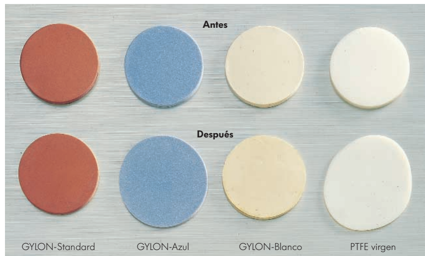
Comparación de diferentes tipos de GYLON con PTFE convencional, cuando son comprimidos a 14\text{ N/mm}^2 durante 1 hora y a una temperatura de 260\text{ }^{\circ}\text{C} .
